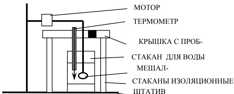
Рис. 1. Схема калориметра
